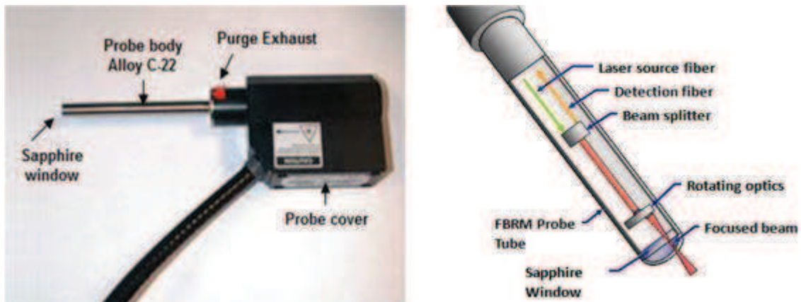
Figure 2. 17. A gauche Capteur FBRM Modèle S400A-8; à droite vue transversal de la sonde FBRM
