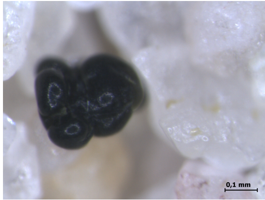
FIGURE 2.25 – Observation au stéréomicroscope d'un oxyde métallique dans le sédiment aptien.
