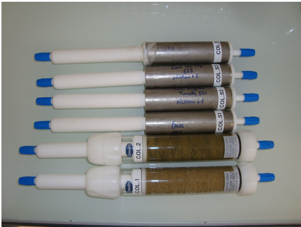
FIGURE 3.9 – Vue des colonnes reconstituées et des carottes prélevées in situ .
