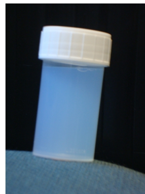
FIGURE 5.19 – Solution contenant des colloïdes de polystyrène et un fond salin de 5 g/L.
