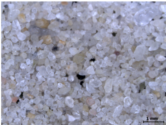
FIGURE 2.15 – Fraction majoritaire du sédiment aptien vue au stéréomicroscope.
