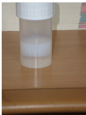
FIGURE 5.18 – Flocculation des colloïdes de polystyrène de 60 nm de diamètre dans une solution fortement saline.
