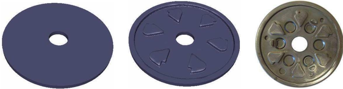
Figure VI-41 : Flasque de mécanisme discontinu : gamme de mise en forme simplifiée simulée avec le logiciel Forge® et pièce réelle.
