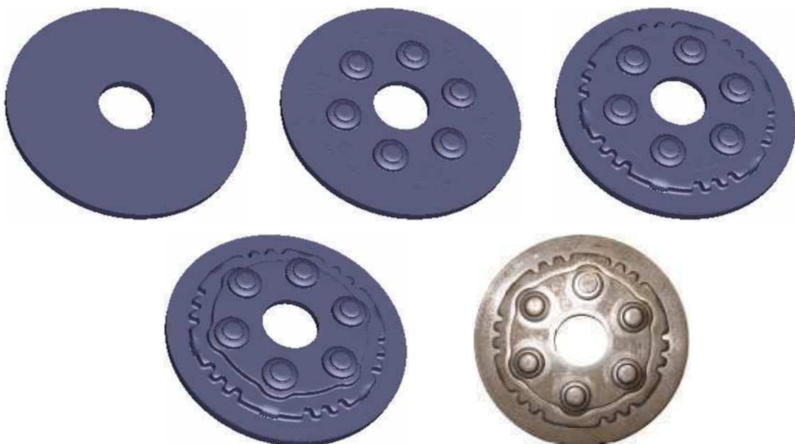
Figure VI-37 : Flasque de mécanisme continu : gamme de mise en forme complète simulée avec le logiciel Forge® et pièce réelle.
