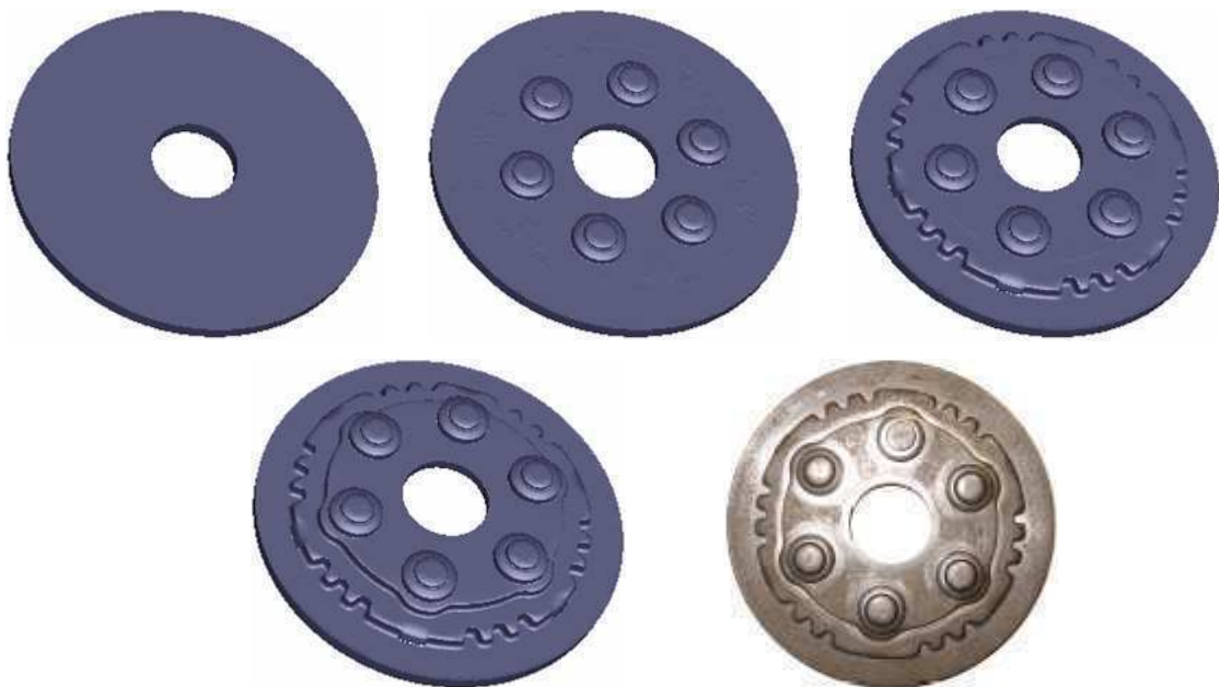
Figure VI-37 : Flasque de mécanisme continu : gamme de mise en forme complète simulée avec le logiciel Forge® et pièce réelle.
