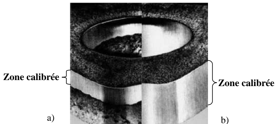
Figure I-5 : Comparaison des bords obtenus par découpage conventionnel (a) et découpage fin (b) (d'après R. Hambli [Hamb 2001b]).
