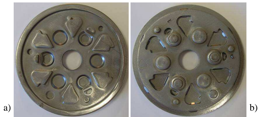
Figure I-1 : Exemple de pièce obtenue par semi-découpe. a) Vue de dessus. b) Vue de dessous.
