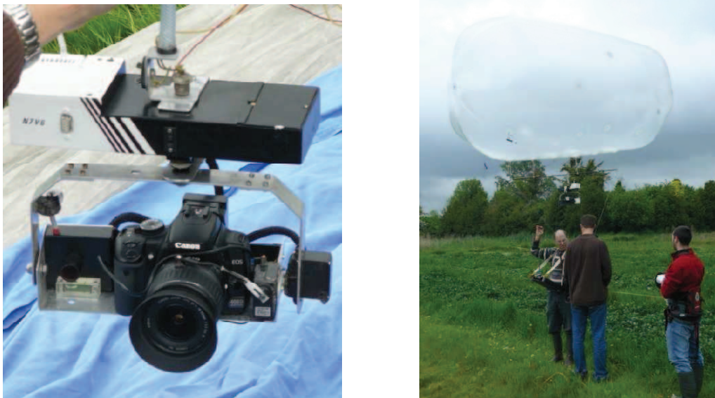
Figure II-4 : Dispositif de prises de vue aériennes par ballon captif. A gauche, nacelle orientable commandée à distance contenant l'appareil photographique. A droite, ballon captif d'hélium auquel la nacelle a été fixée. Photos : C. Meigné
