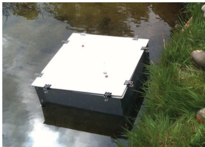
Figure II-11 : Chambre utilisée par G. Vilain pour la mesure de la production de N_2O . Sur le couvercle, des septa permettent de prélever des gaz avec une seringue. Photo : A. Crème.
