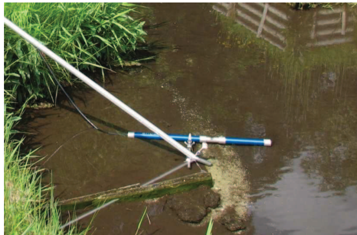
Figure II-9 : La sonde S::CAN «Spectro::Lyser» utilisée in situ , en sortie de fosse. Photo : J. Pulou
