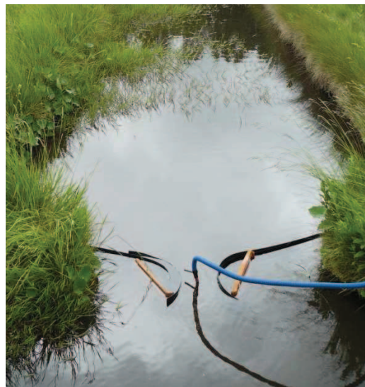
Figure II-6 : Suivi de la conductivité en aval d'une fosse au cours d'un traçage. Photo : C. Meigné
