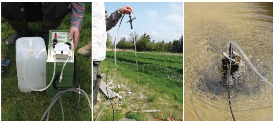
Figure II-5 : Mesure de débit par jaugeage chimique. Photos : J. Pulou
