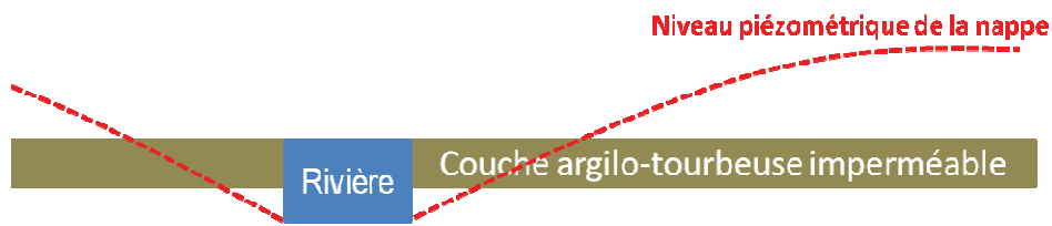
Figure III-9 : Les différences de débits des puits les plus proches de la rivière pourraient provenir d'une diminution du niveau piézométrique de la nappe due à son drainage par la rivière.
