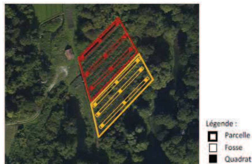
Figure II-19 : Découpage d'un site en unités homogènes (parcelles), choix de 3 fosses par unité et positionnement de 3 quadrats par fosse étudiée. D'après Alabergère (2010).
