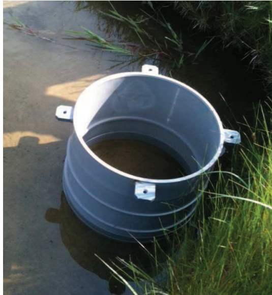
Figure II-10 : Cylindre de PVC utilisé pour la mesure de la dénitrification in situ . Durant l'expérimentation, un couvercle opaque était posé sur le cylindre de façon à empêcher la lumière de passer et la photosynthèse d'avoir lieu. Photo : A. Crème.
