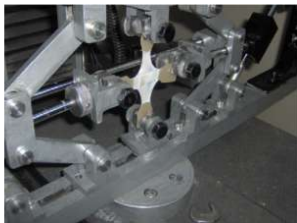
Figure 2-9 : Montage pour essais biaxiaux sur des éprouvettes plates développé par Bhatnagar et al. 2007 (Bhatnagar et al. 2007) : un seul effort imposé verticalement.
