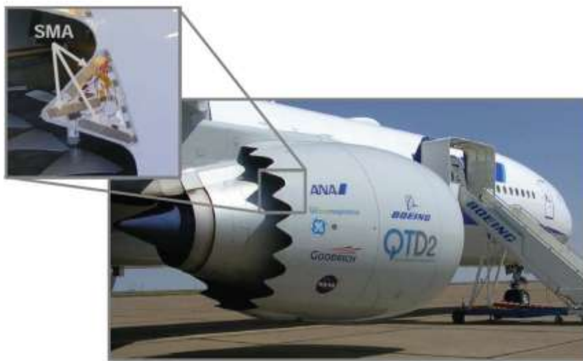
Figure 1-18 : Application de l'effet mémoire double sens assisté – chevrons de réacteur d'avion à géométrie variable (Hartl et Lagoudas 2007).
