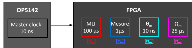
Figure 91 Génération des triggers sur le FPGA
