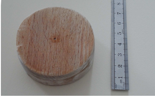
(a) Capillaire unique de diamètre D_1 = 1025\mu m \pm 2,3\mu m
