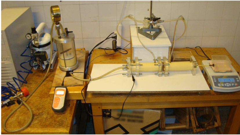
FIGURE 2.28 – Photographie du montage complet pour l'injection de fluide à seuil
