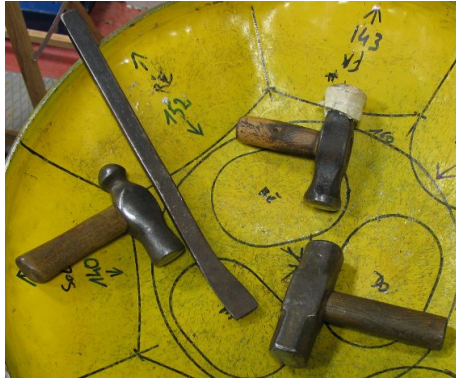
FIGURE 2.16 – Fabrication du steelpan, étape 4 : outils nécessaires au pré-accordage de l'instrument.
