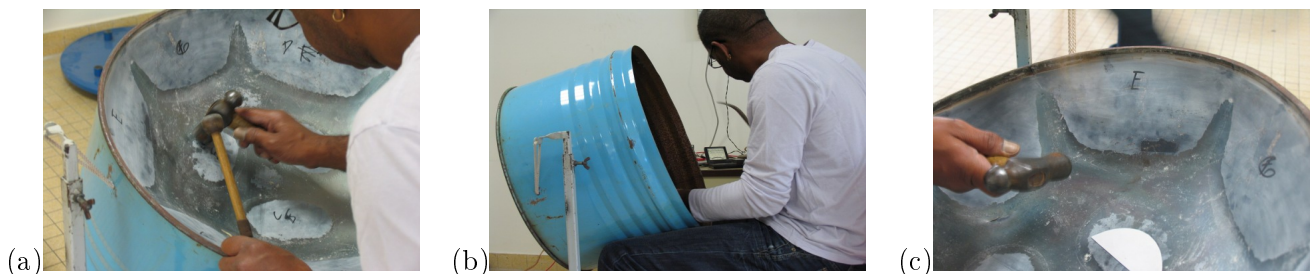
FIGURE 2.24 – Fabrication du steelpan, étape 6 : accordage fin. Martelage des notes en alternance sur la face supérieure (a)-(c) et sur la face intérieure (b).
