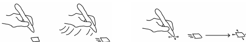
FIGURE 3.3: Les différentes étapes de SuperFlick. L'utilisateur lance d'abord l'objet puis peut effectuer un drag d'ajustement depuis la position d'arrivée.
