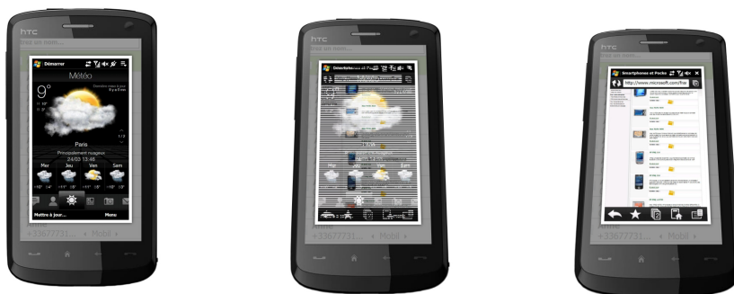
FIGURE 4.6: Effet lenticulaire virtuel en fonction de l'inclinaison du mobile.
