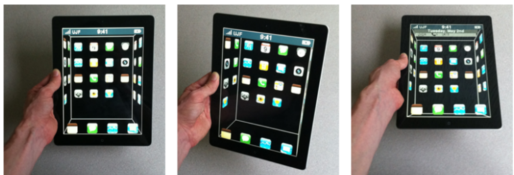
FIGURE 2.16: La métaphore de la boîte proposée par Fracone et al. . En changeant l'orientation de l'appareil l'utilisateur peut accéder aux parties cachées de l'interface.
