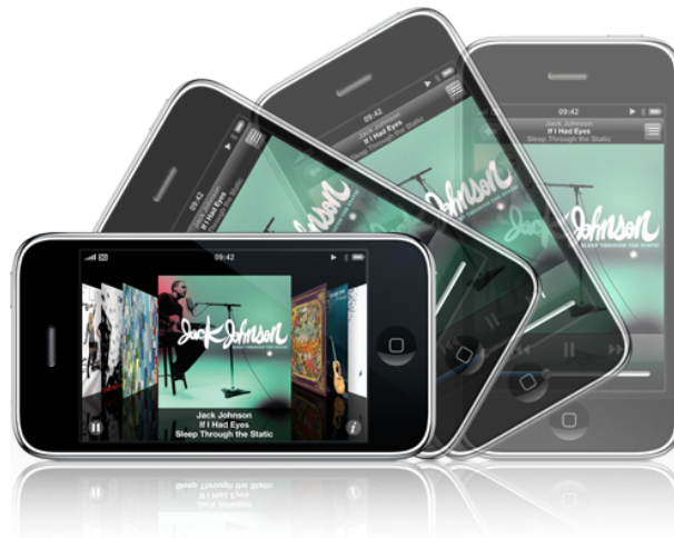
FIGURE 2.8: Changement d'orientation sur l'iPhone grâce à l'accéléromètre.
