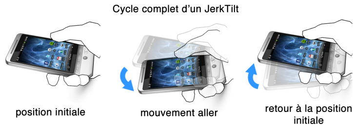
FIGURE 4.11: Cycle complet de réalisation d'un geste de JerkTilts. Le geste part de la position initiale puis revient automatiquement en position initiale en fin de geste.
