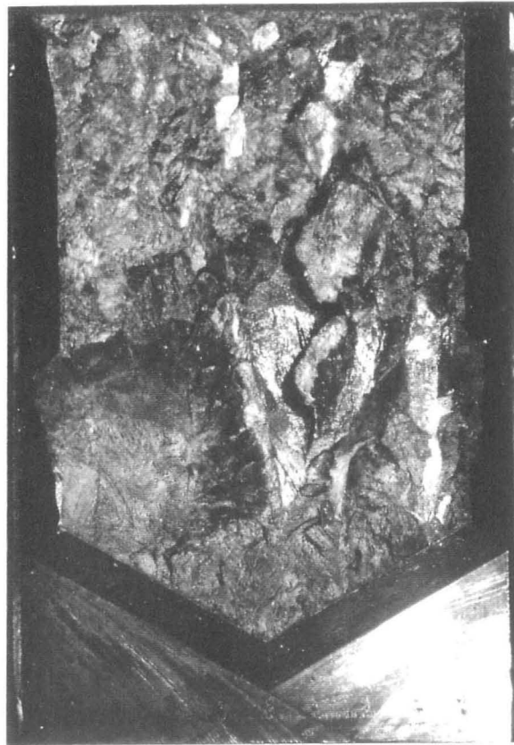
Figure (2.21) (a): Macrographie optique, d'une éprouvette de ténacité de l'alliage Y3296 dans le sens T-R, après bleuissement et rupture.
