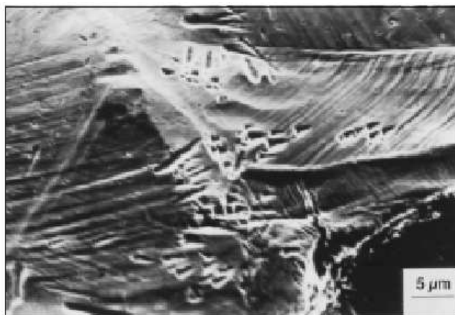
FIGURE 1.20 – Développement des piqûres de corrosion au niveau des bandes de glissement dans l’acier inoxydable 316 SS en milieu 0,5\text{ M NaCl} à pH = 4,2 : f = 10\text{ Hz} , R = 0,05 , \sigma_{max} = 360\text{ MPa} et N_r = 1,7.10^6 cycles [72]
