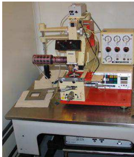
Figure AIII-1 : Photographie de l'aligneur permettant de faire des photolithographies
