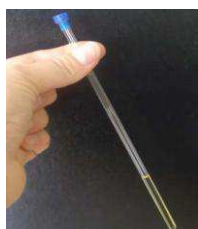
Figure 15 : Echantillon placé dans un tube borosilicé contenant un solvant spécifique.
