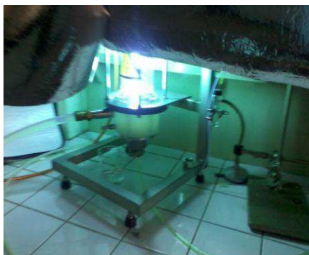
Figure 49 : Réacteur de dégradation photochimique. Laboratoire IRMCP, Université Paul Sabatier.
