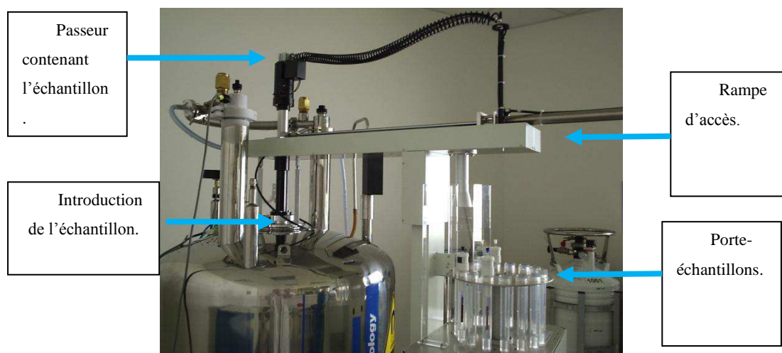
Figure 16 : Passeur et dispositif d'introduction de l'échantillon. Autorisation accordée par l'ENS cachan.
