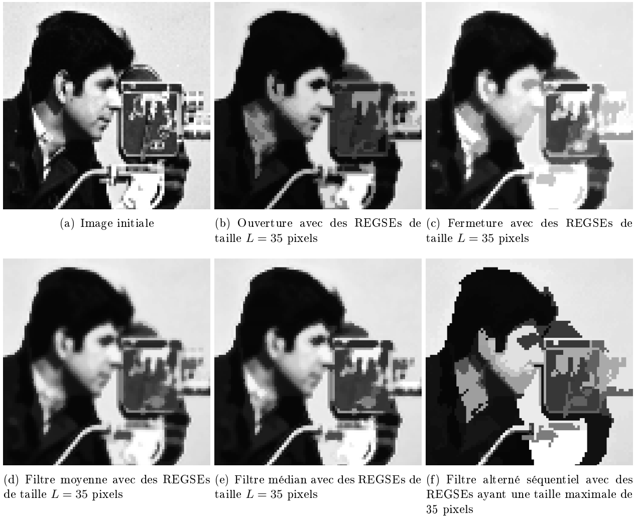
FIGURE 4.6 – Utilisation des REGSEs pour la réduction du bruit sur l'image caméraman. L'image pilote est l'image initiale filtrée par une gaussienne d'écart type 1.
