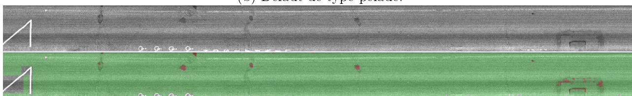
(c) Défaut de type nids de poules comblés.
