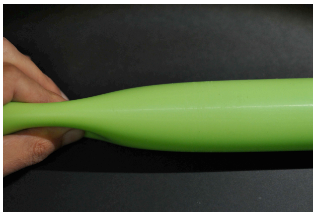
FIGURE 2.7 – Photo d'un cylindre pincé. Nous imposons un déplacement local et modifions la section de la coque à une extrémité. Loin de cette zone, le cylindre retrouve son état initial à section circulaire.
