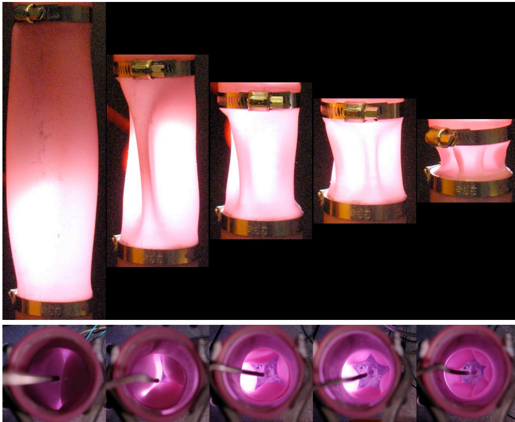
FIGURE 2.5 – Vue latérale et vue de dessus (axiale) d’un cylindre de PVS Shore 8, de rayon R = 18 mm, d’épaisseur h = 2 mm pour différentes longueurs. Le nombre de lobes varie de N = 2 à N = 6 .
