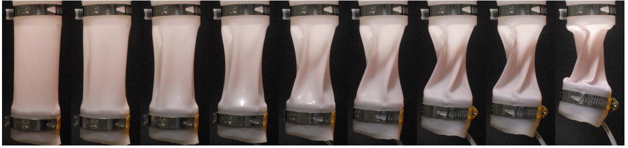
FIGURE 2.23 – Forme du cylindre très loin du seuil de flambement. Pour N > 2 , l'extrémité libre du tube se rapproche axialement de l'extrémité fixée en tournant autour de l'axe du cylindre.
