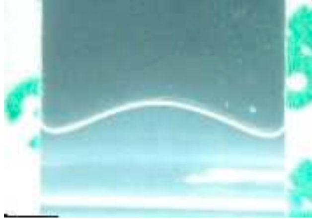
FIGURE 1.11 – Ascension dans une cellule de largeur w = 50 mm, d’épaisseur au bord e_0 = 0,58 mm avec une plaque flexible d’épaisseur a = 0,189 mm et de rigidité flexionnelle B = 1,31 \cdot 10^{-3} Nm. La cellule n’est pas assez souple pour permettre une ascension dans le mode déformable. La plaque flexible se défléchit, le front liquide, légèrement distordu, s’arrête à une hauteur supérieure à la hauteur d’équilibre de Jurin.
