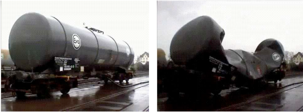
FIGURE 2.2 – Photo d'un réservoir industriel en acier, soumis à une dépression interne, avant et après effondrement. Éviter le flambement de tels réservoirs demeure un enjeu industriel.
