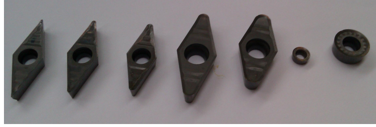
FIGURE 10.14 Plaquettes utilisées avec des rayons de bec allant de 0.4 à 6 mm
