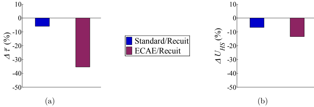
FIGURE 14.8 Evolution relative des paramètres par rapport au CuD35-R : (a) Contrainte de cisaillement en usinage \bar{\tau} ; (b) Energie de déformation U_{HS} (essais de cisaillement)
