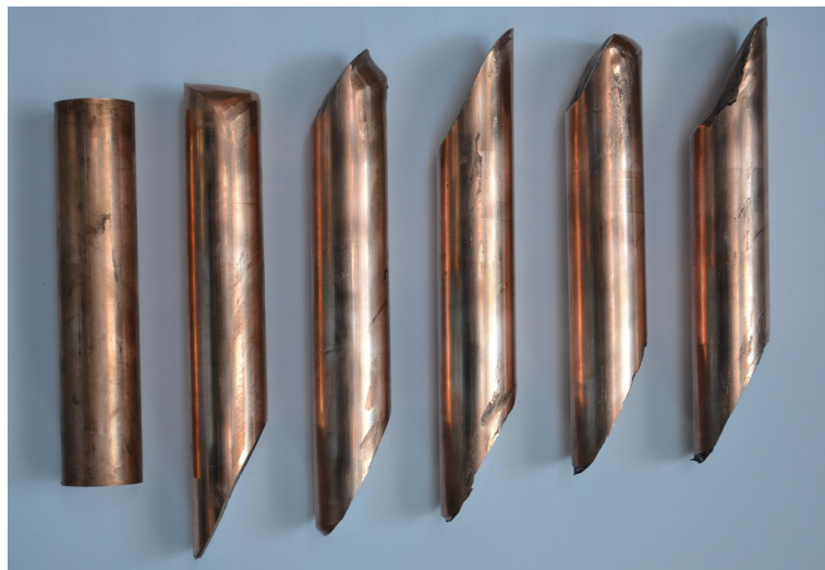
FIGURE I.1 Lopins dans différents états (de gauche à droite) : état initial, premier lopin extrudé par l'outillage, puis lopins après une, deux, trois et quatre passes
