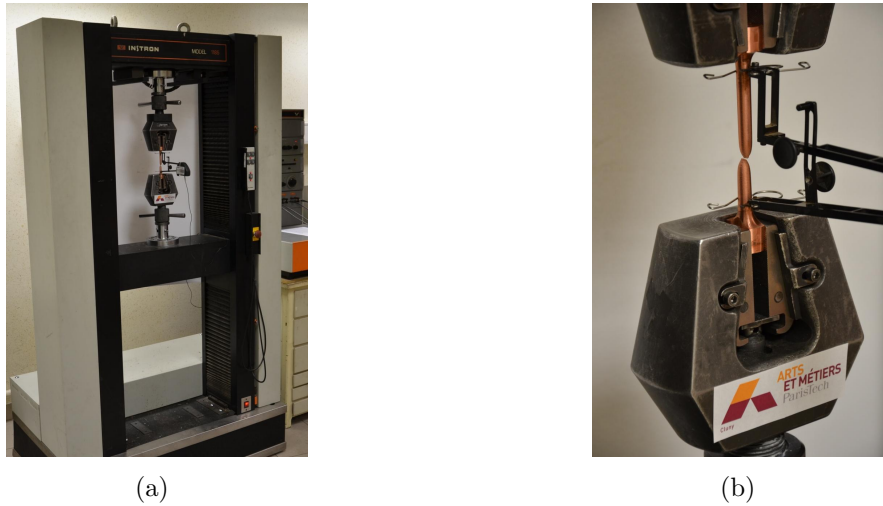
FIGURE 13.5 Essais de traction : (a) Machine Instron 1185; (b) Eprouvette après rupture
