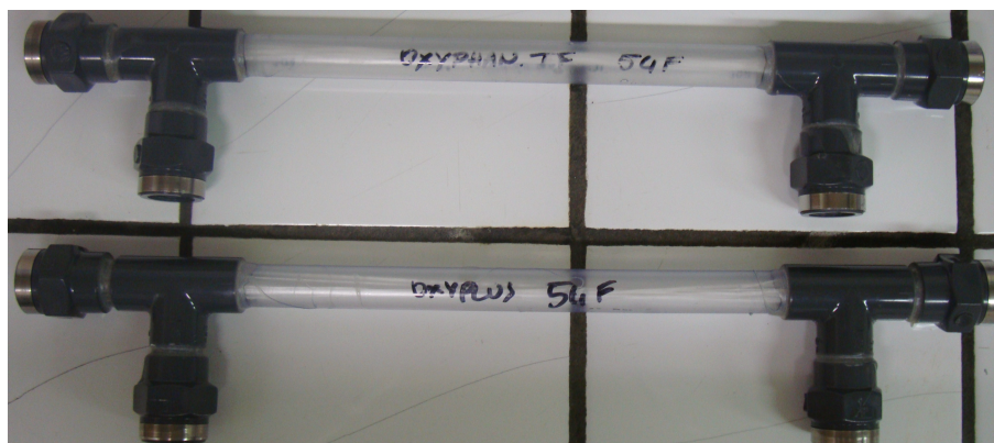
FIGURE 3.1 – Contacteurs membranaires avec deux types de fibres
