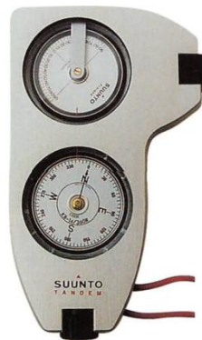
Figure 35 : Photo d'un clinomètre. L'instrument du haut est un « inclinomètre » et l'instrument du bas est une boussole)
