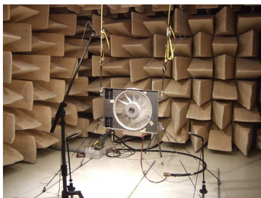
Figure 2.3: Photo d'un module de refroidissement suspendu sismiquement dans une chambre semi-anéchoïque. La distance entre le centre de l'hélice et le sol est de 1m. Le microphone placé dans l'axe est à 1 m du centre de l'hélice en amont du GMV (distance mesurée en fonctionnement).
