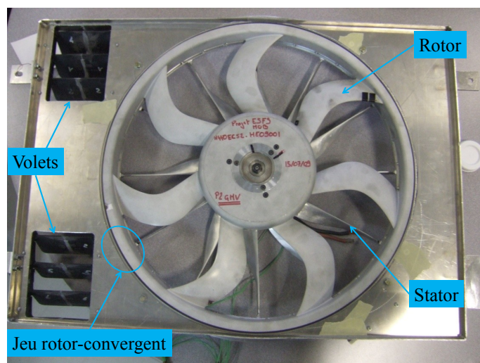
Figure 4.1: Le GMV H440EC52 utilisé comme cas-test pour la prédiction du bruit tonal
