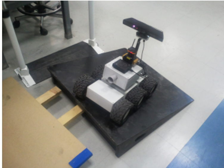
FIGURE 5.30 – Test de CoreSLAM2 sur une rampe.
