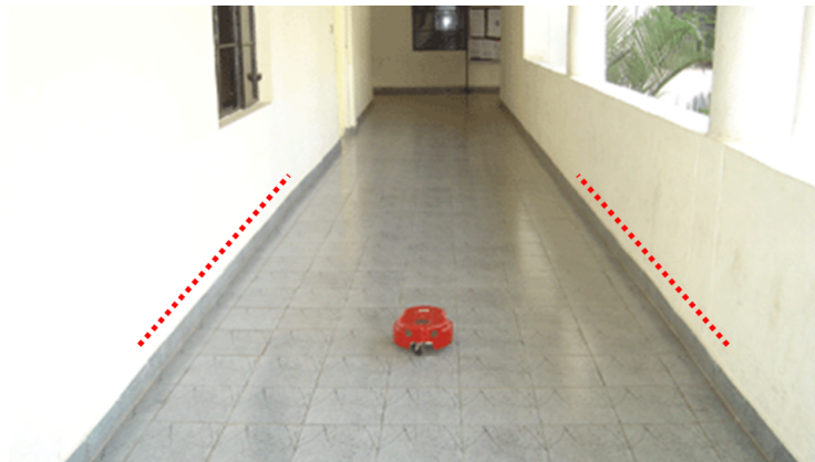
FIGURE 7.1 – Illustration du problème du couloir pour un capteur laser
