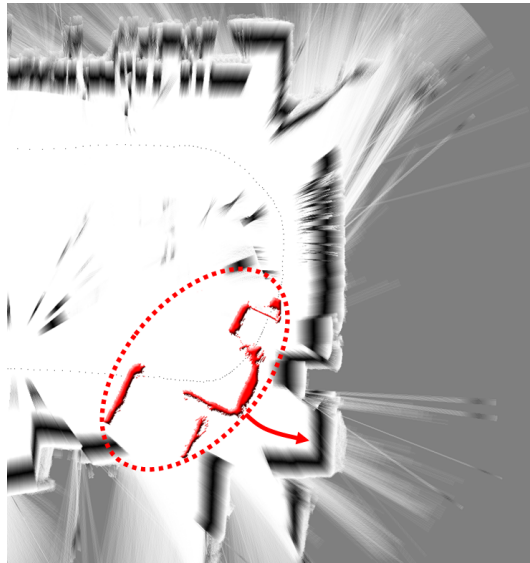
FIGURE 6.9 – Nous décalons une partie de la carte et nous demandons à l’algorithme de localisation de retrouver la position d’origine.
