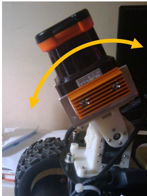
FIGURE 5.29 – Utilisation du bioloid pour réaliser des captures de nuages de point 3D
