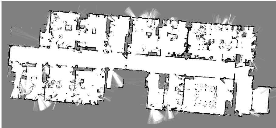
Figure 6.23 – Carte CoreSLAM du bâtiment 079 de l’université de Freiburg
