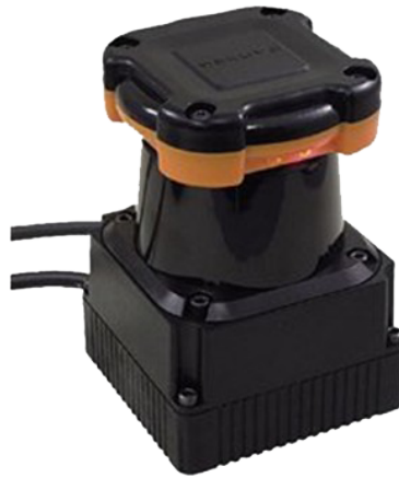
FIGURE 3.2 – Le capteur UTM 30LX est plus performant. Son utilisation dans le cadre du concours CAROTTE a permis d'améliorer tinySLAM vers CoreSLAM
