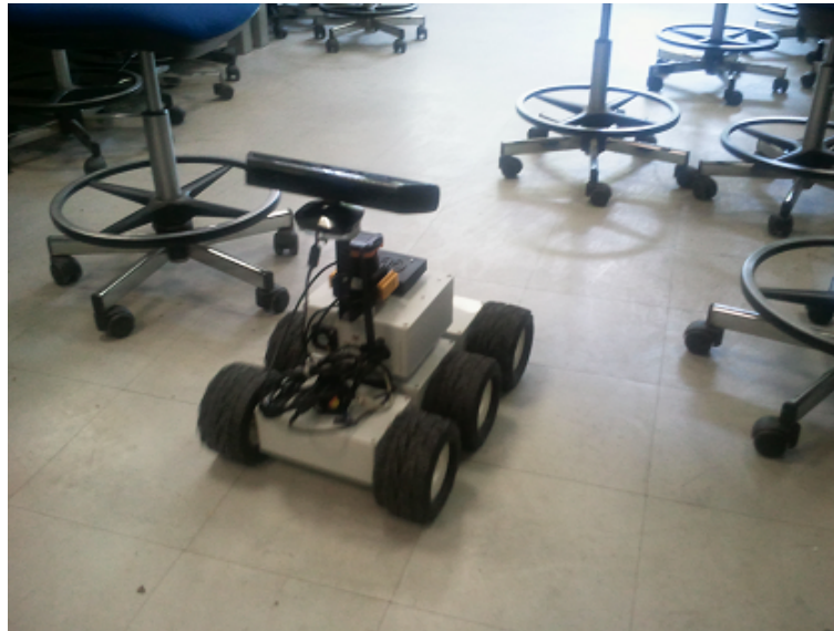
FIGURE 5.27 – Le CoreBot M en plein évitement des chaises roulantes. Les roulettes ne sont vues que par la Kinect (voir la figure 5.26 )
