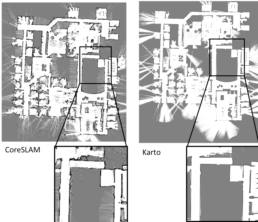
Figure 6.20 – Comparaison entre CoreSLAM et le logiciel Karto
