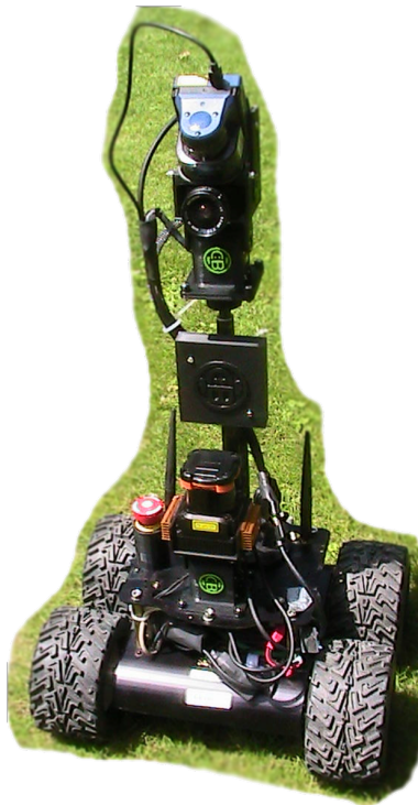
FIGURE 5.11 – Le robot CoreBot 1 est basé sur l'architecture Wifibot Lab V2
