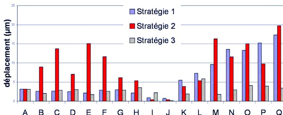
FIGURE 5.6 – Défaut de localisation des perçages en fonction de la stratégie utilisée
