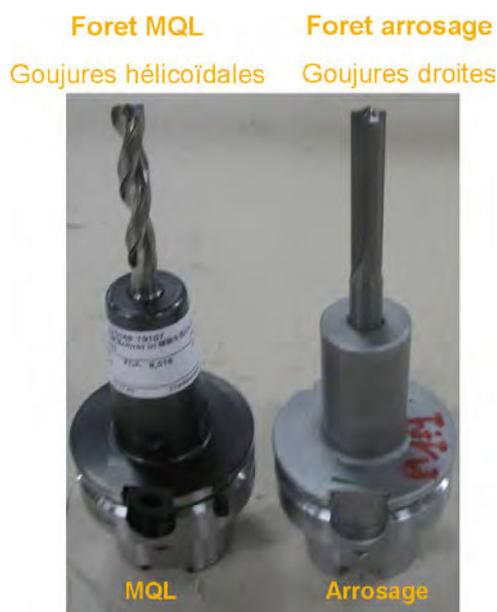
FIGURE 2.3 – Exemple d'un foret MQL et d'un foret arrosage
