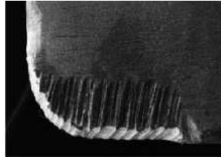
FIGURE 2.2.4: Usure par abrasion d'une plaquette de coupe après usinage d'un alliage de titane [CAST 99]
