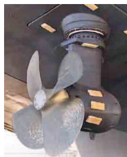
(d) Propulseur azimutal de l'Orleans (source : Steerprop)
