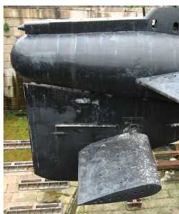
(b) Barre de plongée arrière du sous-marin britannique HMS Ocelot
