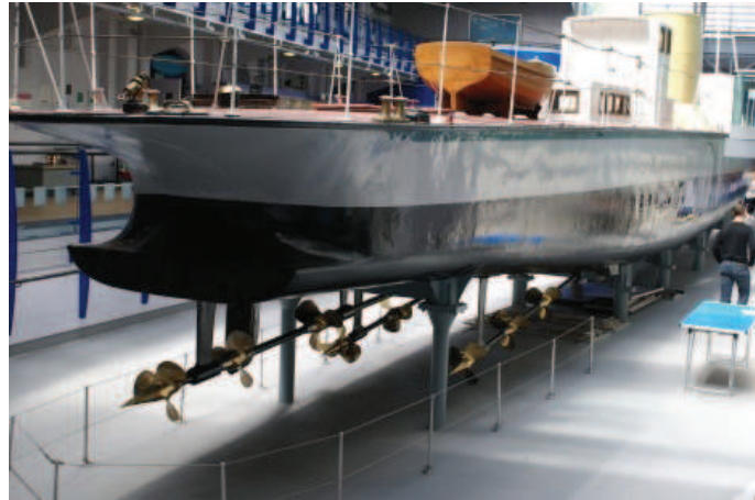
(b) Propulseurs du Turbinia (source : http://www.soue.org.uk/souenews/issue8/turbinia.html )
