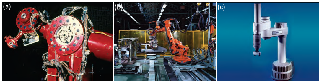
FIGURE 1.3 – (IFR, 2012) (a) Le premier robot piloté par moteur électrique (b) Le premier bras d'entraînement direct du monde (c) premier robot SCARA à entraînement direct
