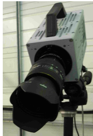
FIGURE 5.18 – Lasers utilisés pour mesurer la position d'outil et caméra rapide pour analyser la réaction du robot pendant le procédé FSW
