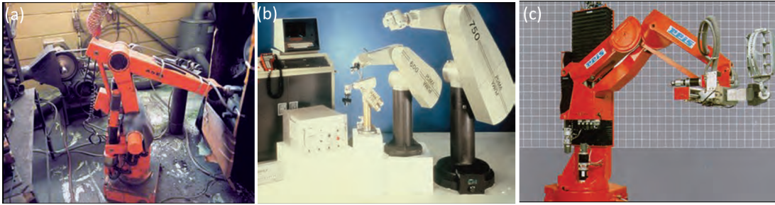
FIGURE 1.2 – Le robot tout électrique (IFR, 2012) (a) ASEA IRB-6 (1973), le premier tout-électrique et (b) PUMA : le robot travaille en coopération avec des opérateurs
