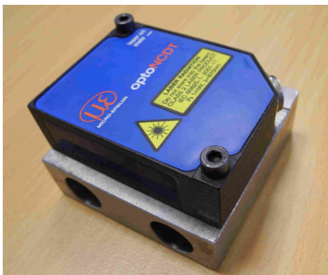
FIGURE 5.18 – Lasers utilisés pour mesurer la position d'outil et caméra rapide pour analyser la réaction du robot pendant le procédé FSW
