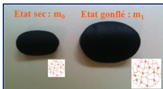
Figure 37. Echantillon d'EPDM avant et après gonflement.
