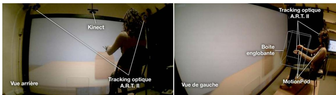
Figure 4-4 : Un utilisateur pendant l'expérimentation et détail du dispositif
