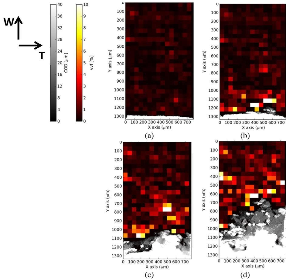
Fig. IV-8 Maximum void volume fraction and COD maps for  $\delta_5 =$  (a)  $0\mu\text{m}$  (b)  $27.6\mu\text{m}$  (c)  $42.5\mu\text{m}$  and (d)  $56.9\mu\text{m}$ .
