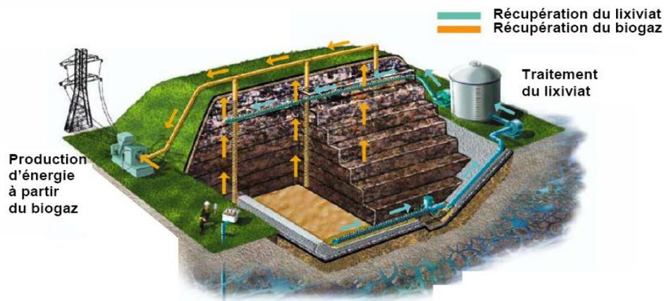
**Figure 3 : Schéma d'une installation de stockage de déchets non dangereux.**
