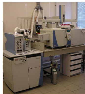
Figure 22 : Couplage chromatographie en phase gazeuse-combustion-spectrométrie de masse isotopique.
