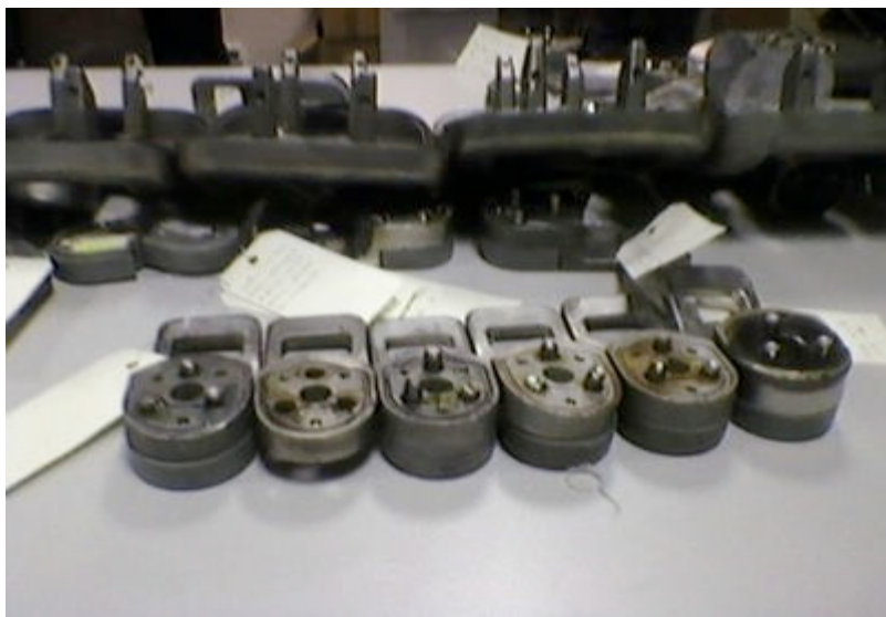
Figure 42 : Lames cassées prêtes à être analysées
