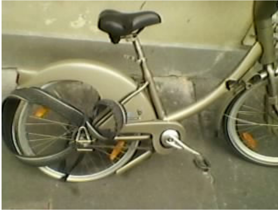
Figure 24 : Vélo avec pneu crevé et cadre cassé
