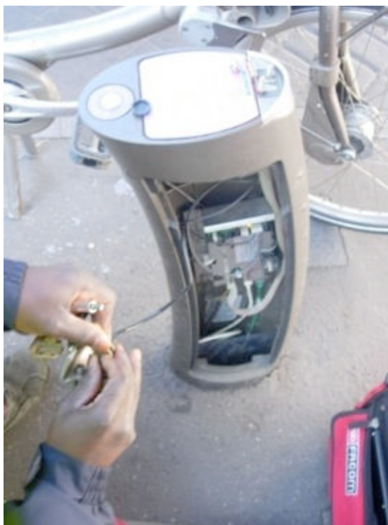
Figure 12 : Le TC1 en train de réparer la bornette
