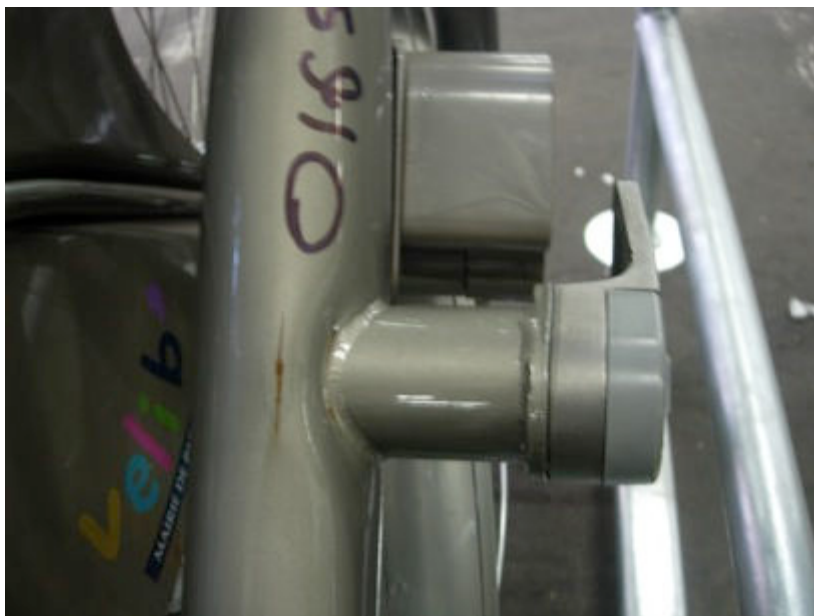
Figure 44 : Vélo avec un cadre abimé non renforcé
