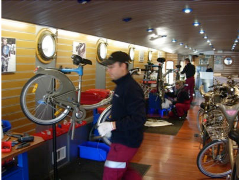
Figure 76 : Un mécanicien avec son « pied de réparation » (Atelier-péniche)
