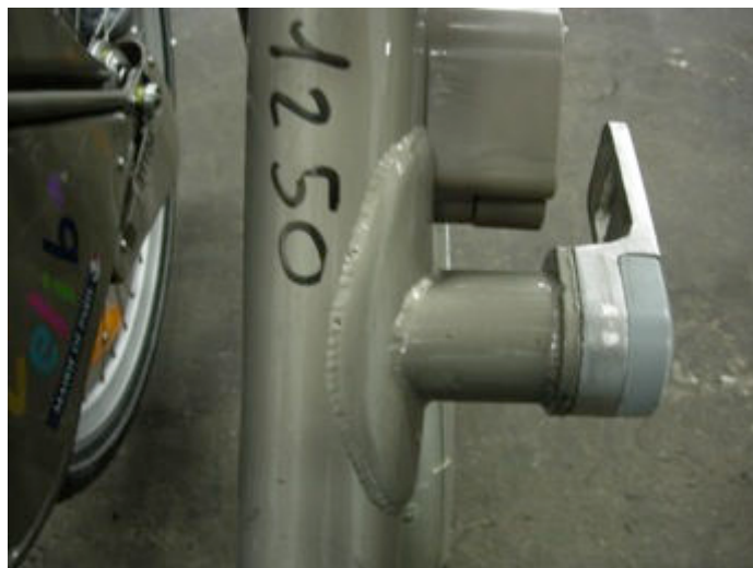
Figure 45 : Vélo avec un cadre renforcé
