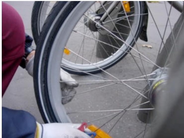
Figure 17 : Agent en train de réparer un pneu crevé
