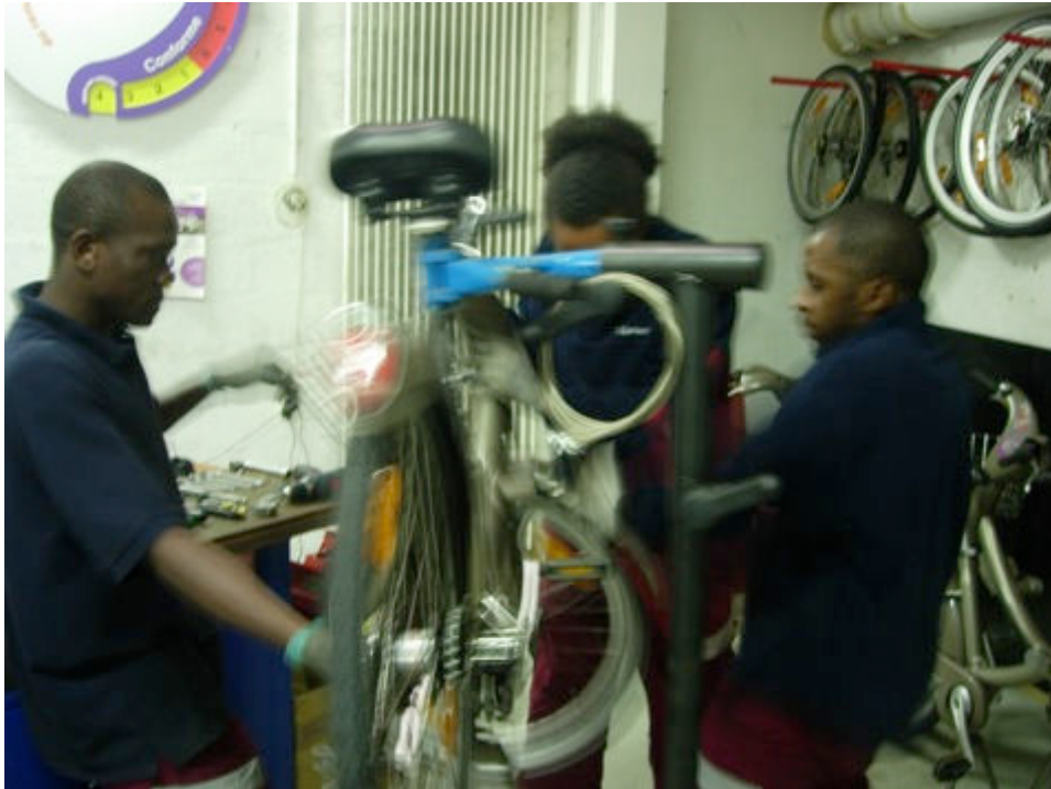
Figure 80 : Trois mécaniciens en train de retirer les inserts d'un cadre
