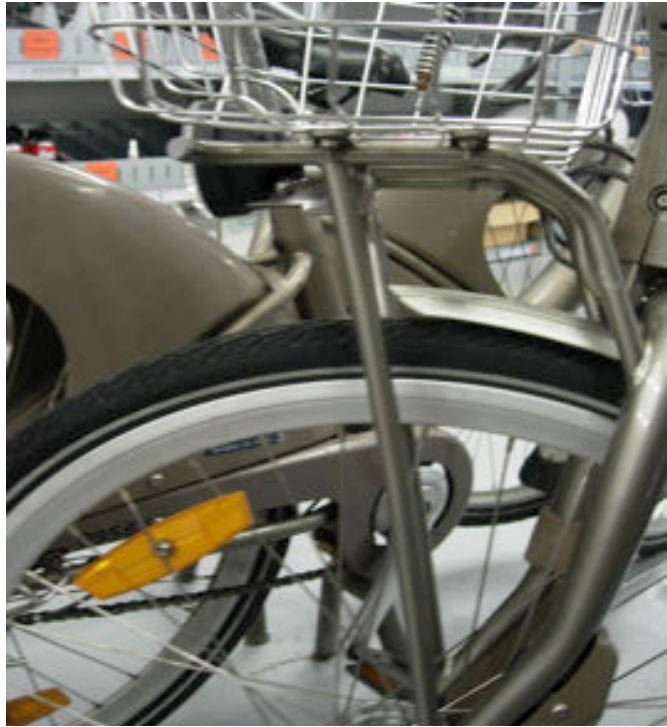
Figure 39 : Fourche avec des tubes solidifiés
