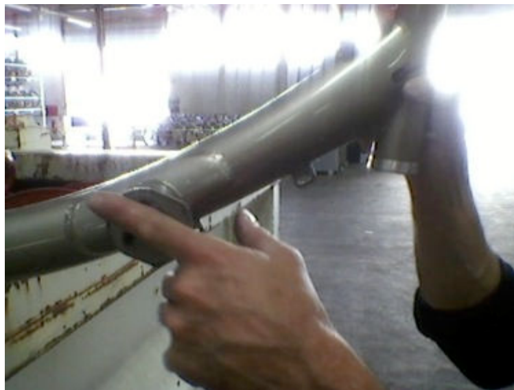
Figure 68 : Vélo avec un cadre abîmé
