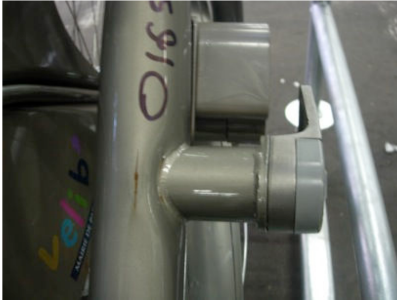
Figure 44 : Vélo avec un cadre abimé non renforcé
