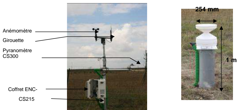
Figure 3-14 : Station météorologique Basic Weather Station BWS-200 (a) et pluviomètres AUG 100 (b)
