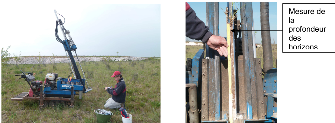
Figure 3-19 : Carottier pneumatique (à gauche) et tube cylindrique de prélèvement (droite).
