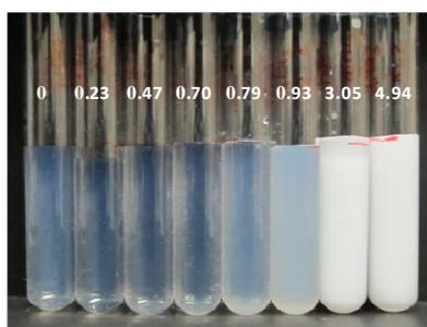
**Figure 4** : Photo des suspensions de silice modifiée par le diméthoxydiméthylsilane à des densités de greffage croissantes (de gauche à droite). La densité de greffage, indiquée en nombre de greffons par  $\text{nm}^2$ , est indiquée sur chaque échantillon.
