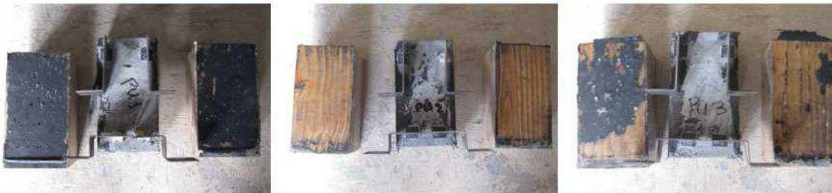
Figure 3-14 : Photos des éprouvettes PU1, PU2, et PU3 (polyuréthane) après rupture.
