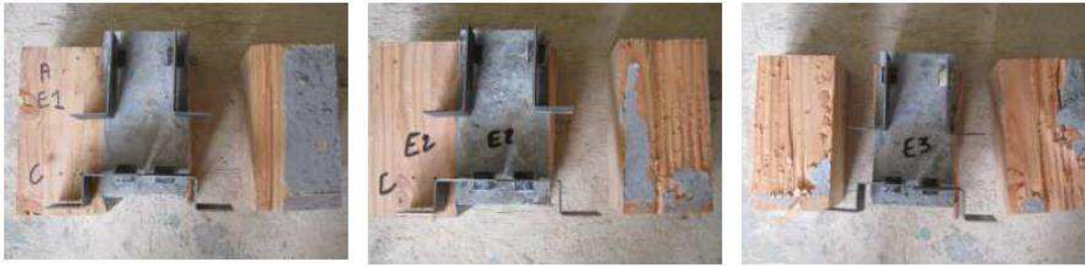
Figure 3-12 : Photos des éprouvettes E1, E2, et E3 (Sikadur 30) après rupture.
