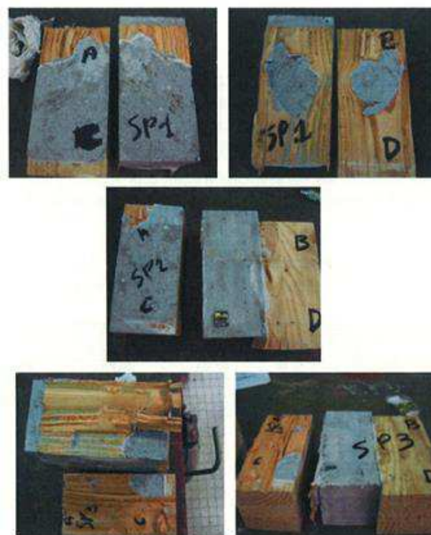
Figure 3-8 : Faciès de rupture des échantillons sans primaire (échantillons SP1, SP2, SP3).
