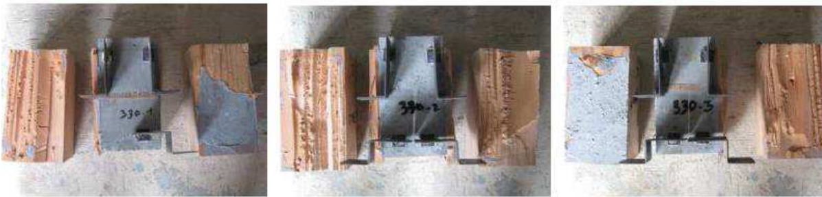
Figure 3-13 : Photos des éprouvettes 330-1, 330-2, et 330-3 (Sikadur 330) après rupture.
