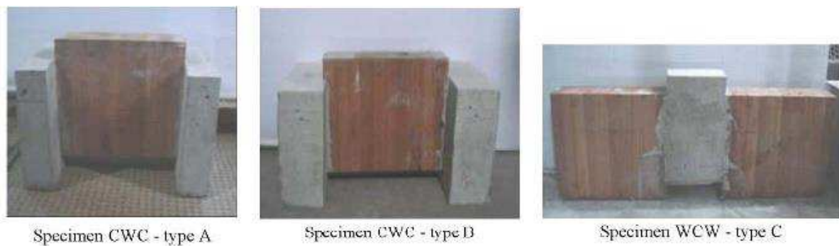
Figure 1-30 : Éprouvettes Push-Out testées dans Carvalho et al. (Carvalho & Mantilla Carrasco, 2010).
