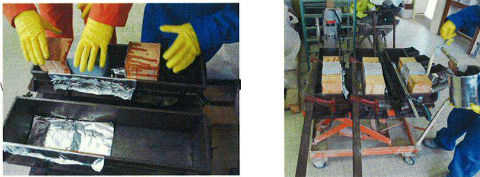
Figure 3-6 : Fabrication des échantillons Push-Out - série préliminaire (série 0, (Chataignier 2009)).
