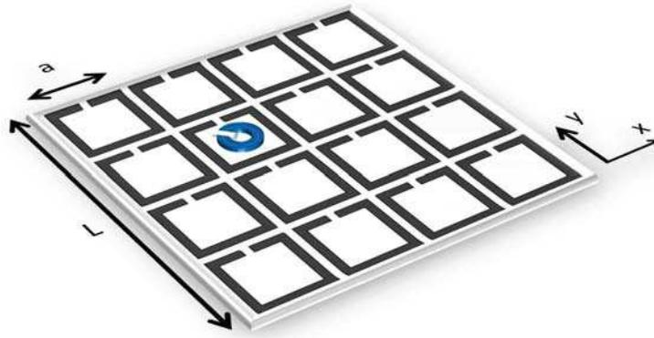
**Figure II.8** – Schéma du réseau plan fini de 4 par 4 SRR
