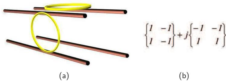
**Figure V.27** – (a) Schéma d'une configuration pour l'imagerie IRM utilisant deux boucles de courant en quadrature. (b) Somme des deux modes dégénérés d'une structure à 4 résonateurs électriques.
