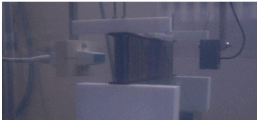
**Figure 3.5** – Photo du montage expérimental. Un train d'onde est émis par un mono-élément et se propage à travers une forêt de tiges ( $\varnothing = 0,8$  mm,  $L = 46$  mm,  $n = 29,54$  tiges/cm<sup>2</sup>). Les ondes transmises, multiples et diffusées, sont enregistrées sur un réseau de 64 éléments.
