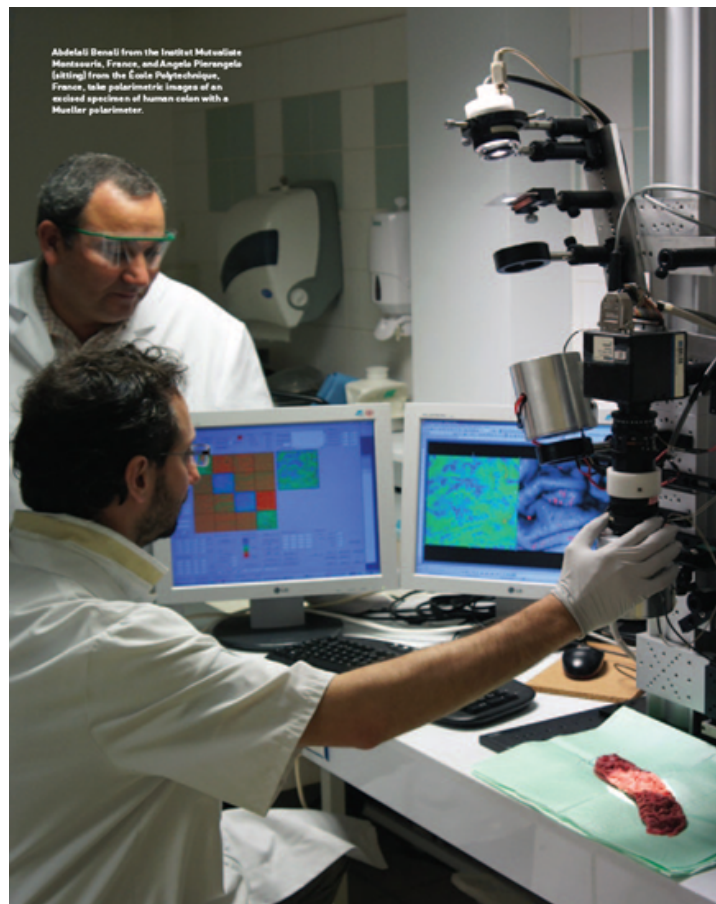
FIGURE 4.3 – Photo de l’instrument en cours d’utilisation sur un échantillon de colon.
