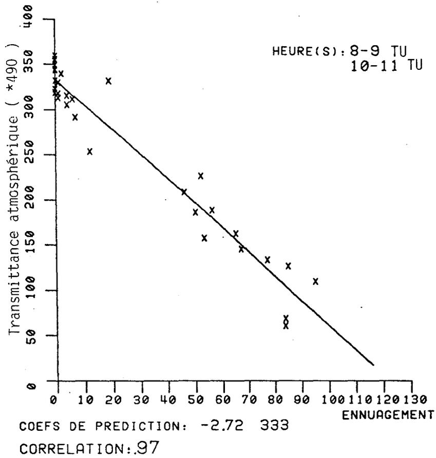
FIGURE IV.1 : Exemple de la relation linéaire entre l'indice d'ennuagement (satellite) et la transmittance atmosphérique (pyranomètre) .
