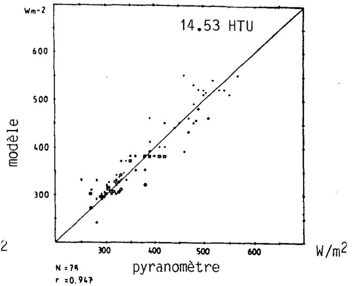
FIGURE III.14 : Comparaison entre le rayonnement global horaire mesuré (pyranomètre) et le rayonnement global horaire estimé (satellite).
