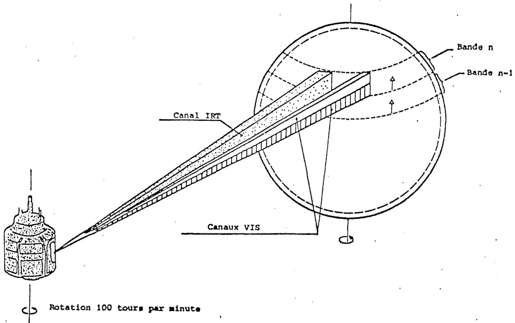
FIGURE B.3 : Schéma de l'acquisition d'une image par Météosat.
