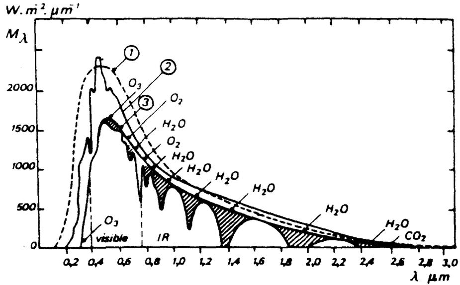
Figure I.5 : Répartition spectrale du rayonnement solaire (d'après PERRIN DE BRICHAMBAUT et VAUGE, 1982)
