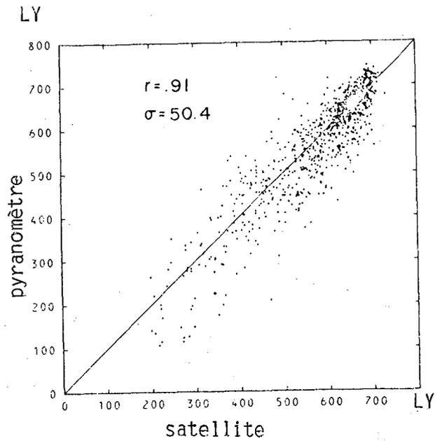
FIGURE III.2 : Comparaison du rayonnement global journalier estimé par satellite et du rayonnement global journalier mesuré par pyranomètres .
