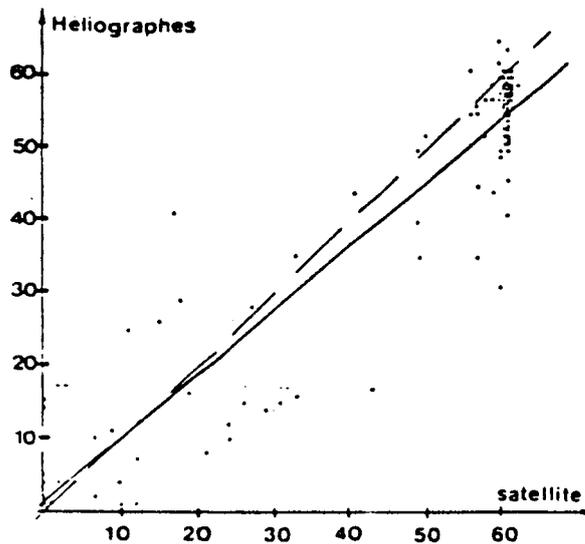
FIGURE III.4 : Comparaison des mesures de durée d'insolation par héliographe et satellite pour le 6 septembre 1979 matinée.
