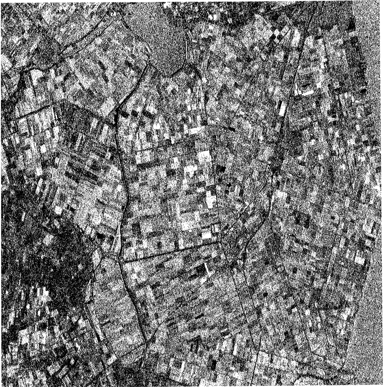
Figure 4.4c. Mêmes image que la figure 4.4a. traitée par un filtre de Wiener associé à la transformée en ondelettes et à l'analyse multirésolution.
