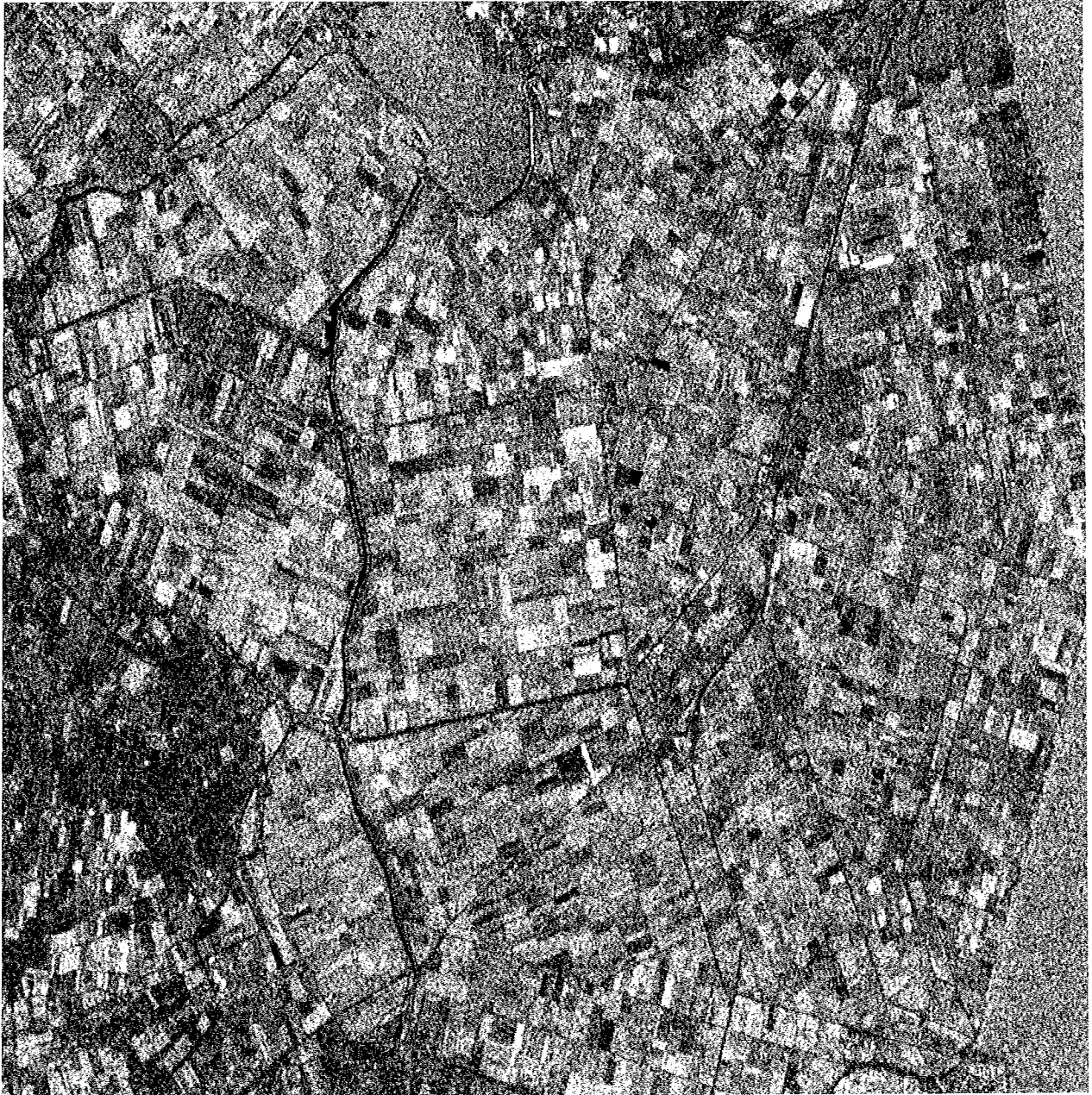
Figure 4.4b. Môme image que la figure 4.4a. traitée par un filtre de Wiener classique.
