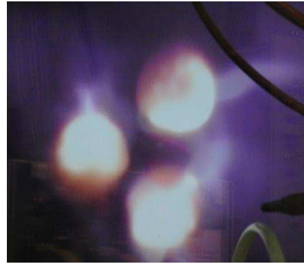
Figure 11 Ancien dispositif plasma triphasé avec une configuration des électrodes angulaire utilisée lors des précédents travaux [Ravary 1998], avec à droite la photo d'un arc obtenu avec cette configuration.
