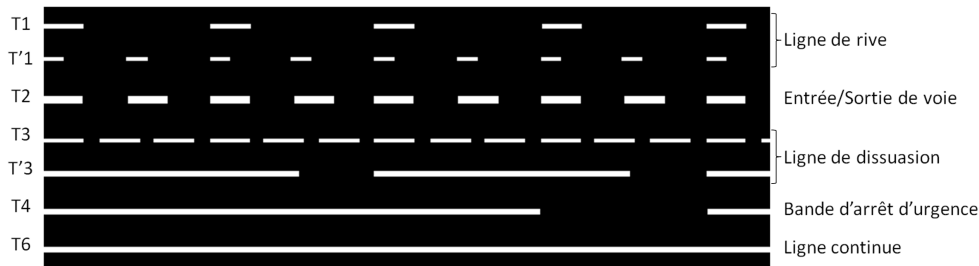
FIGURE 5.7 – Types de marquages existants en France. Chaque type est caractérisé par trois mesures : la largeur, la longueur et l'espacement entre deux traits. Les lignes de rive (T1 et T'1) séparent les voies du même sens de circulation. Les marquages T2 indiquent la présence d'une entrée ou sortie de route. Les lignes de dissuasion (T3 et T'3) interdisent le dépassement des autres véhicules (sauf très lents). Les bords de route sont indiqués par les types T4 (sur autoroute) et T6.
