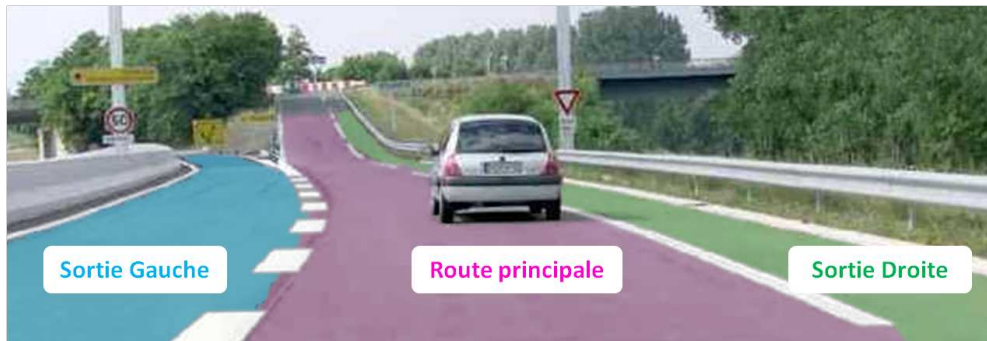
FIGURE 5.12 – Séparation de la route en trois espaces. La Route Principale (RP) correspond à l'espace sur lequel circule actuellement le véhicule et les panneaux appartenant à cette file seront donc ceux qui s'appliqueront. Les voies de Sortie Gauche (SG) et Droite (SD) sont associées aux panneaux détectés sur les voies latérales.
