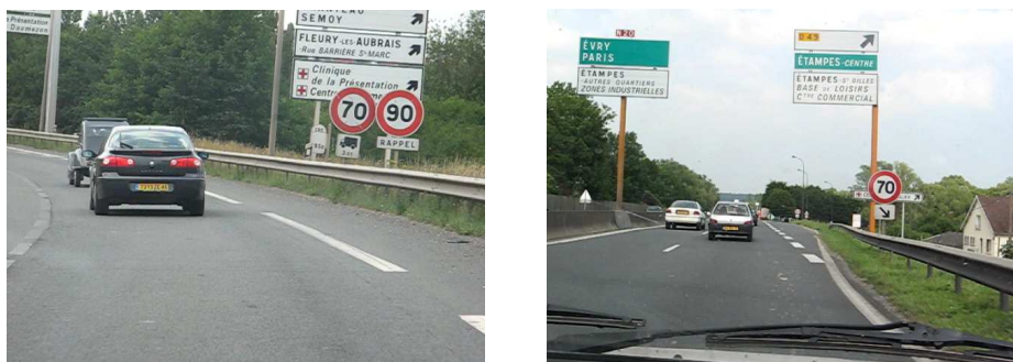
FIGURE 2.1 – Illustrations de situations pour lesquelles la vitesse limite dépend du contexte spécifié par le panonceau. À gauche : La vitesse limite de 70 km/h ne s'applique qu'aux véhicules de plus de 3.5 tonnes tandis que le panneau 90 s'applique à toutes les autres catégories de véhicules. L'information "Rappel" n'apporte aucune information supplémentaire. À droite : La vitesse limite de 70 km/h ne concerne que la voie de sortie située à droite, comme spécifié par le panonceau "Flèche". Les véhicules qui circulent sur la route principale ne sont pas affectés.
