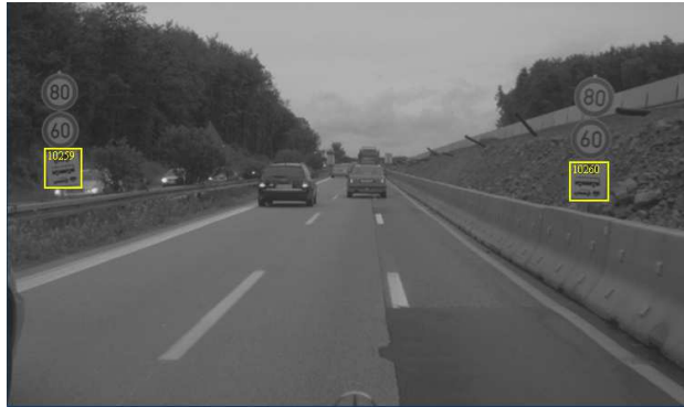
FIGURE 2.22 – Création de vérité terrain à l'aide de SamGT. Chaque objet d'intérêt, ici des panneaux, est associé à une boîte englobante (en jaune) et un identifiant unique.
