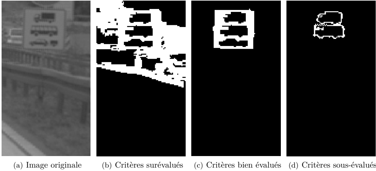
FIGURE 2.13 – Influence du choix des critères \kappa_L et \kappa_G sur la qualité de la segmentation. (b) Une surévaluation d’une valeur fait croître la région au-delà des limites attendues. (d) En revanche, une sous-évaluation arrête le processus bien trop tôt.
