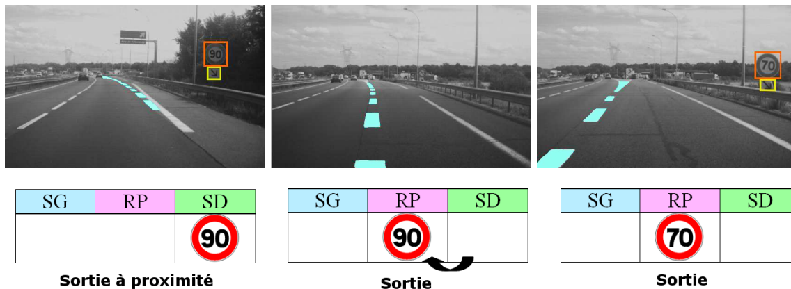
(a) Le panneau détecté est associé à la voie de sortie (b) Franchissement du marquage de sortie (c) Le panneau est applicable à la voie courante
