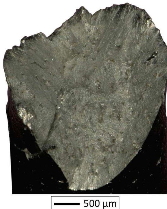
Figure 7-9 : faciès de rupture de l'éprouvette FM01 (microstructure F_{OPTI} ) testée à température ambiante.
