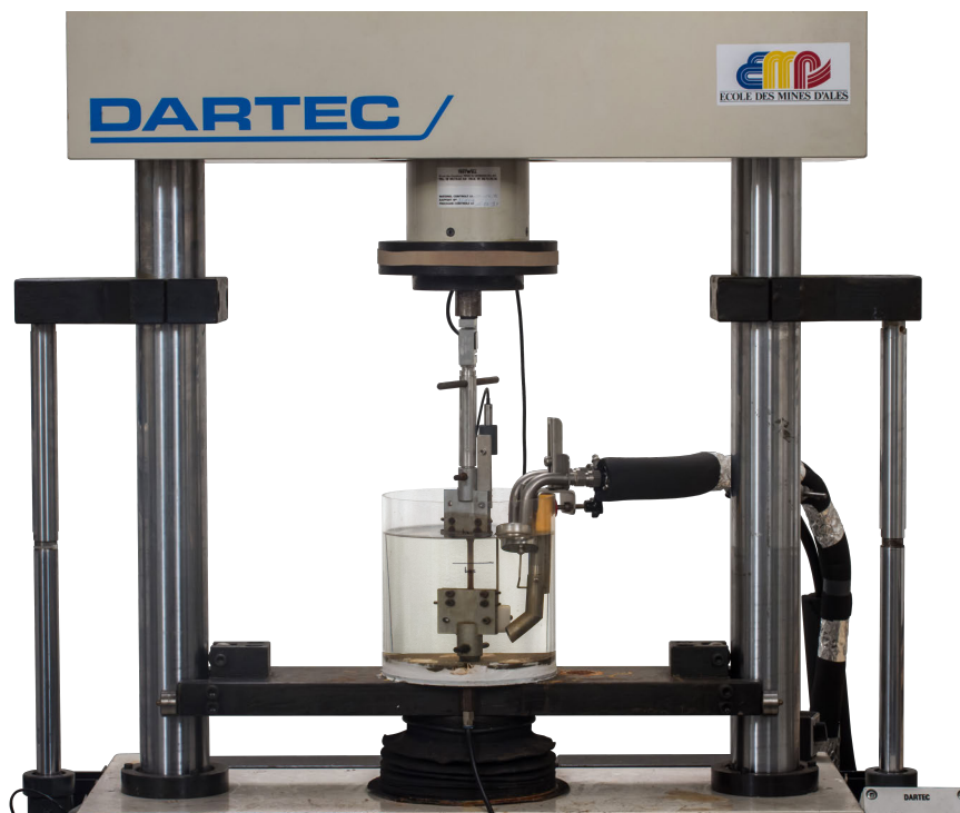
FIGURE 6.3 – Presse de traction Dartec 100kN équipée du montage de vieillissement thermo-hydro-mécanique
