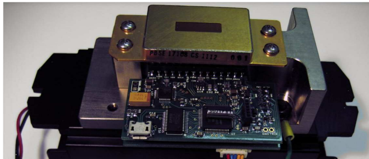
FIGURE 4.21 – Barrette de détecteurs PbSe utilisée ainsi que son électronique de contrôle et de refroidissement.
