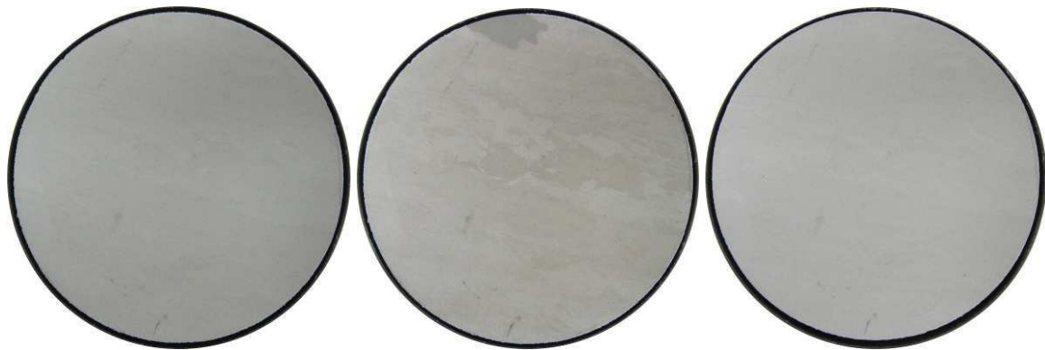
Figure 3.4 : Exemples de photos d'échantillon de APS au cours des cycles de dessiccation-humidification
