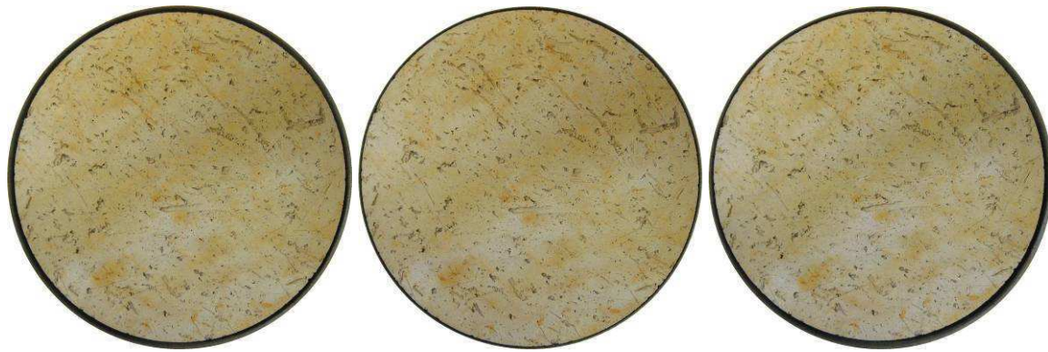
Figure 3.5 : Exemples de photos d'échantillon de API au cours des cycles de dessiccation-humidification
